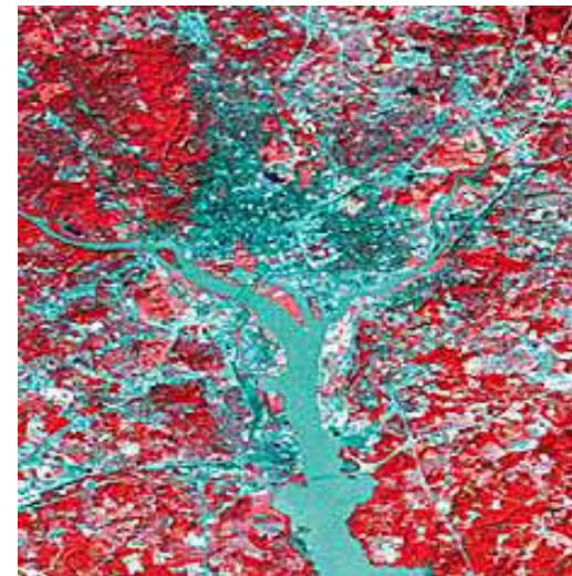
80 meter multispectral (Landsat - MSS)
